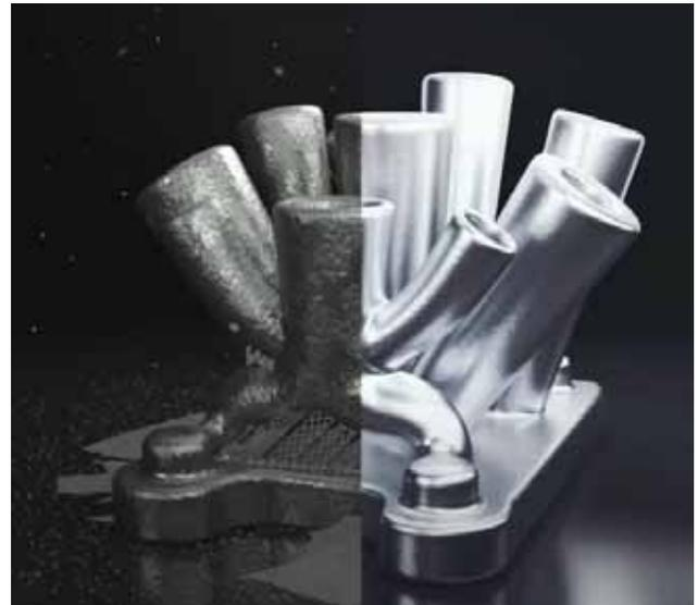
Şekil 5. Hirtizasyon prosesi uygulanmış parça.
