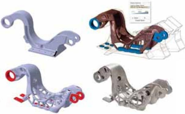
**Şekil 2.** Krüger kanat braket için yapılmış DfAM çalışması, ASCO ve SLM Solutions®.
