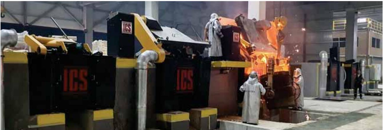
Kutluk Döküm, 1850kW ICS Dual Melt 2x2000kg+1000kg 3 potalı ergitme sistemi döküm yaparken, ICS İndüksiyon Sistemleri-2022
