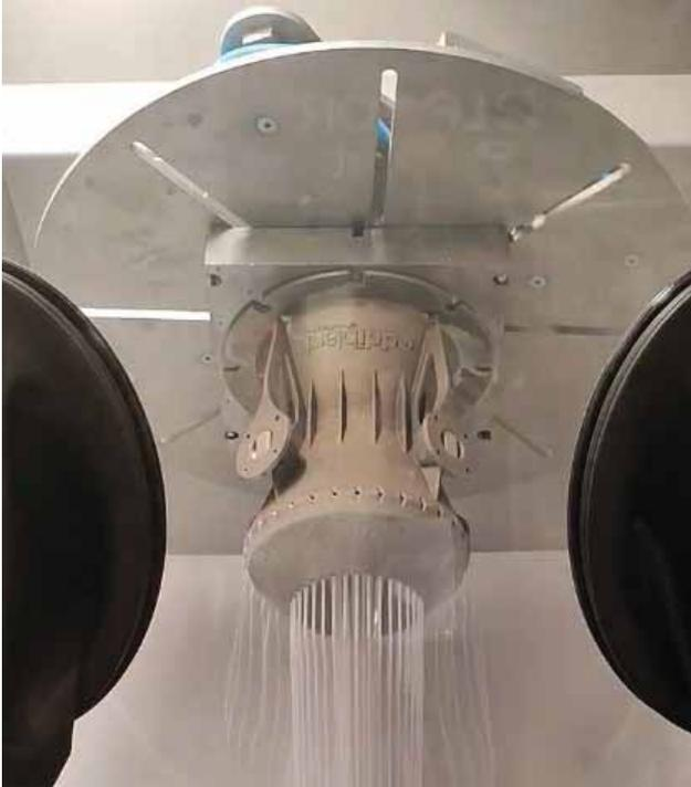
Şekil 4. Addiblast sistemlerinde toz temizleme işlemi.
